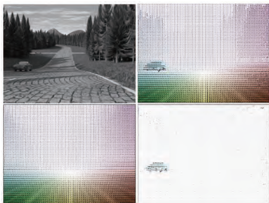
車載カメラ映像(左上)から見てとれる動き(右上)をスパースモデリングで解析すると、カメラが移動することによる動き(左下)と、対向車などの物体の動き(右下)に分けることができる
